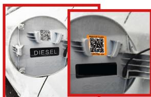
Ein QR-Etikett bringen Sie auf der Innenseite der Tankklappe/ Ladeklappe an.
