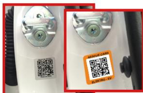
Das dritte QR-Etikett bringen Sie an der B-Säule der Fahrzeugseite an, die der Tankklappe/Ladeklappe gegenüberliegt.
